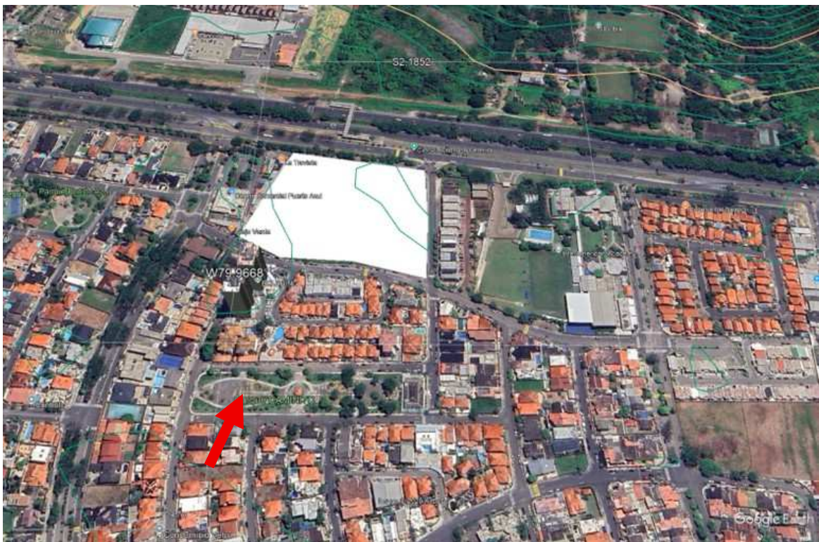
Foto 1: Ubicación del área del proyecto en relación al parque Caminito, área verde sobre el terreno natural, el que está a una cota notoriamente más baja que los sitios de salida de los manantiales subterráneos. En el parque Caminito que está en dirección del proyecto, no existen flujos de agua .
