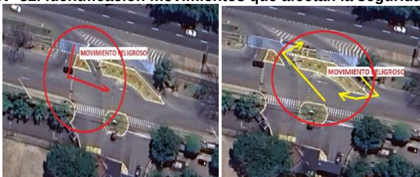
Figura. N° 32. Identificación movimientos que afectan la seguridad vial
