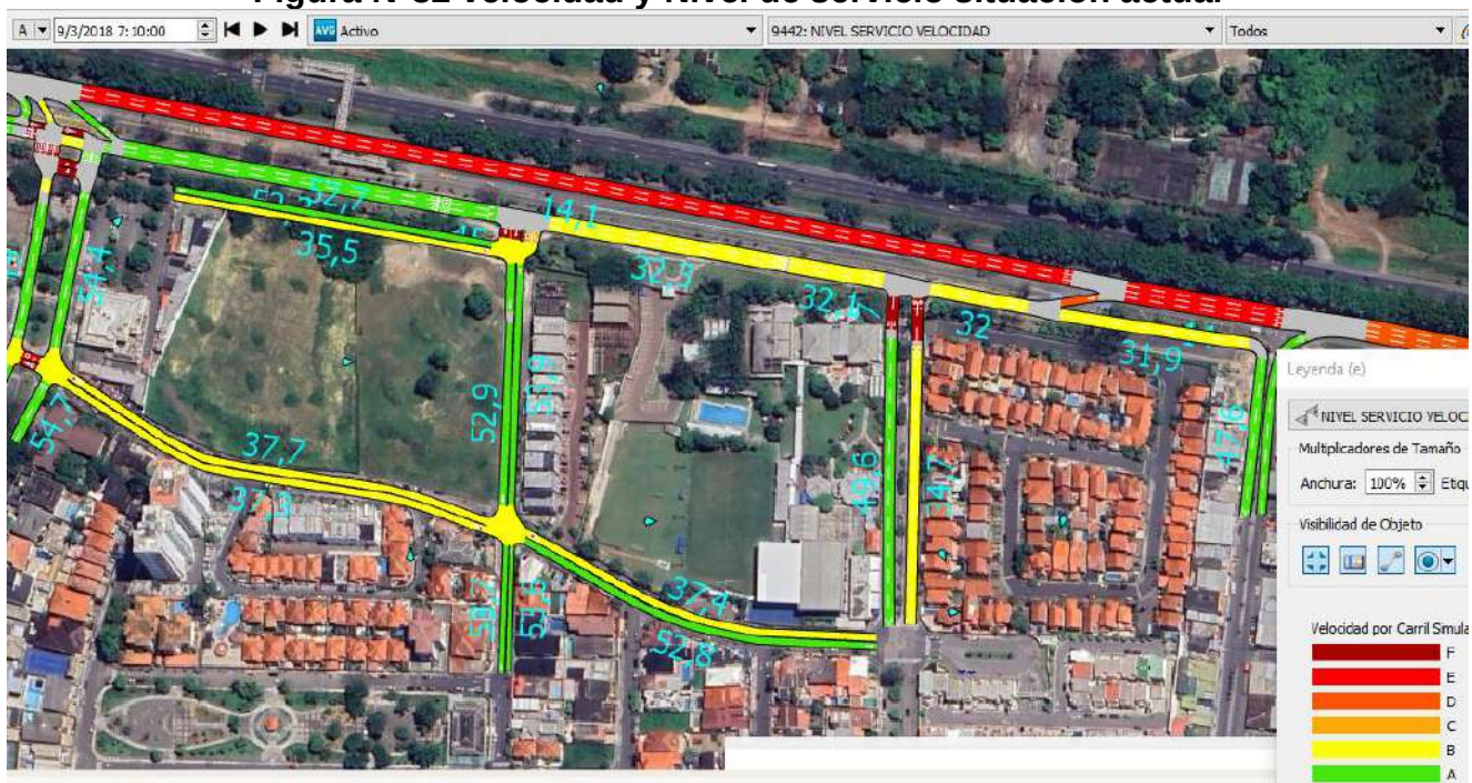
Figura N°32 velocidad y Nivel de servicio situación actual
