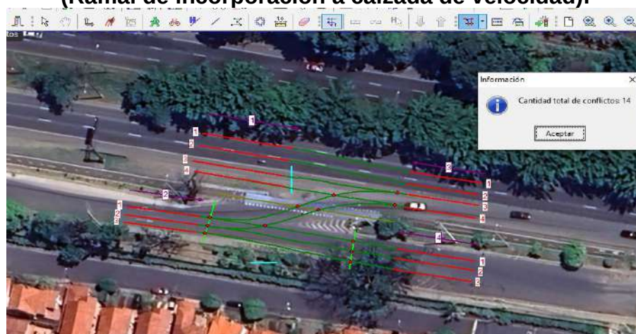
Figura. N° 27 Identificación de movimientos y puntos de conflicto (Ramal de incorporación a calzada de velocidad).
