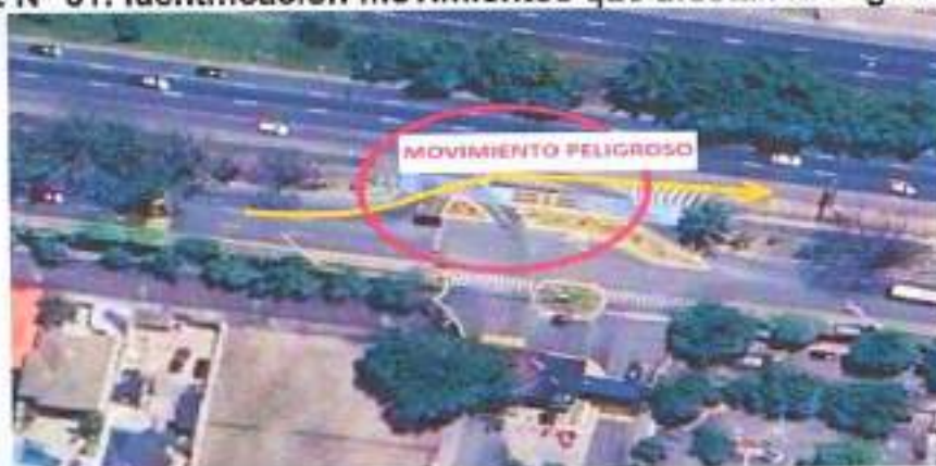
Figura. N° 31. Identificación movimientos que afectan la seguridad vial
